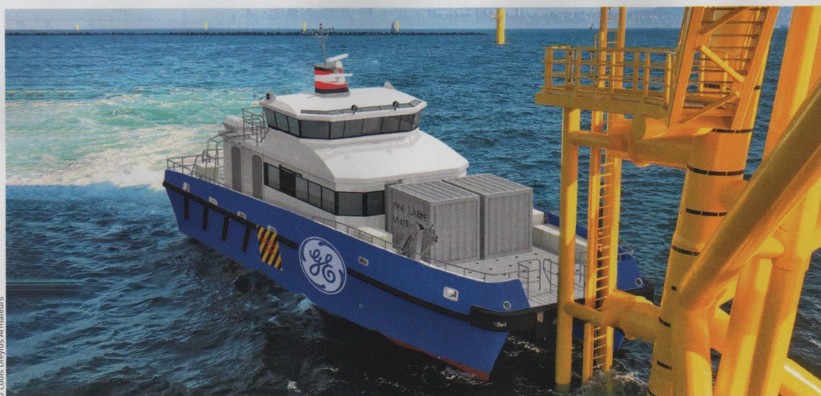
Les crew transfer vessels permettent de déposer et de récupérer le personnel travaillant sur les éoliennes.
